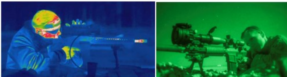
Figura 4 – Detalhamento das imagens. Imageador térmico, à esquerda; Intensificador de imagens, à direita.
