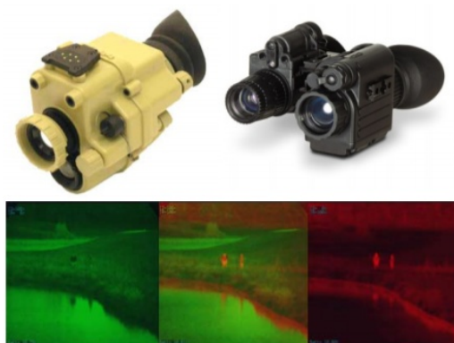
Figura 10 – Exemplos de INVS e imagens geradas por intensificador de imagens (à esq.), imagem térmica (à dir.) e imagem combinada (abaixo).
