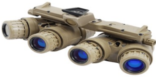
Figura 9 – Exemplo de intensificador de Imagens ocular e imagem adquirida.
